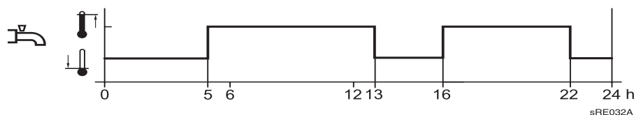
Rys. 18: Uruchamianie funkcji podgrzewania c.w.u. zgodnie z 4. programem sterowania zegarowego (przykład)
